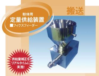
粉体を定量的に供給する重量式定量供給装置です。ロード セルとコントロールにより、供給量の補正をリアルタイムに行い ます。スクリューの本体は工具レスにてケース・スクリュー軸を 分解でき、容易に洗浄が行えます。
