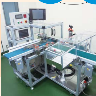
独自開発による複合検査装置(印字、印字検査、テープ検査を一体化することで省スペース化に貢献)
